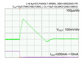
XC9247B VIN=12V, VOUT=5.0V, IOUT=10mA→500mA
