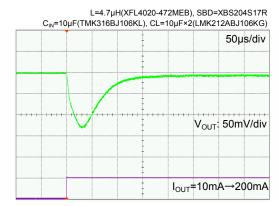
$\begin{array}{c} \text{XC9246B} \\ \text{V}_{\text{IN}}\text{=}12\text{V}, \, \text{V}_{\text{OUT}}\text{=}3.3\text{V}, \, \text{I}_{\text{OUT}}\text{=}200\text{mA} \rightarrow 10\text{mA} \end{array}$
