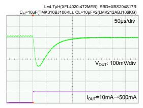
$\begin{array}{c} \text{XC9247B} \\ \text{V}_{\text{IN}}\text{=}12\text{V, V}_{\text{OUT}}\text{=}3.3\text{V, I}_{\text{OUT}}\text{=}500\text{mA} \rightarrow 10\text{mA} \end{array}$
