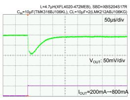
$\label{eq:comparison} $\text{XC9246B}$ $V_{\text{IN}}$=12V, $V_{\text{OUT}}$=3.3V, $I_{\text{OUT}}$=800mA$ $\rightarrow$200mA$ }$
